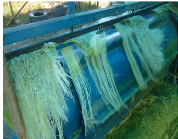
Gambar 5. Mesin dekortikator konveyer serat dibersihkan dari kotoran
