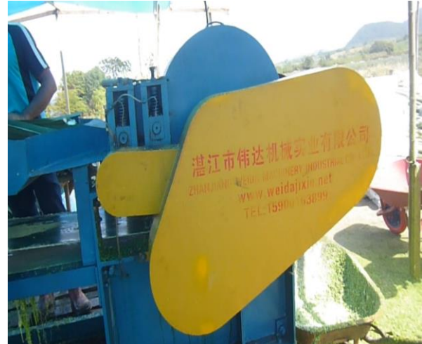
Gambar 7. Mesin dekortikator konveyer terlihat membuang limbah.
