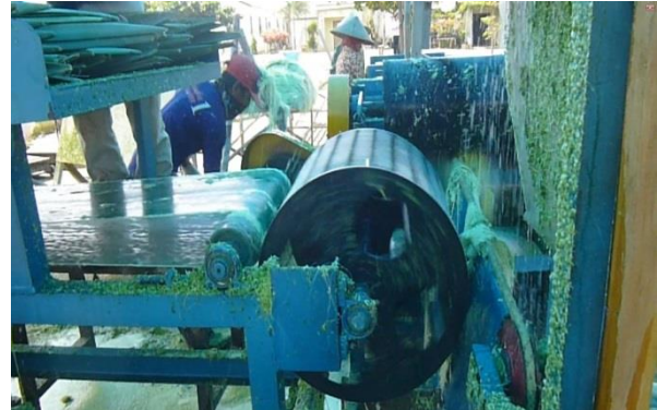
Gambar 3. Mesin dekortikator konveyer, daun Agave berjalan masuk mesin
