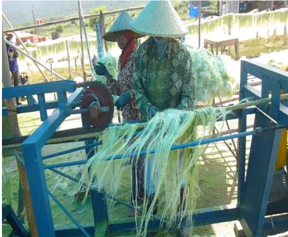
Gambar 6. Mesin dekortikator konveyer serat yang sudah bersih diambil untuk dijemur
