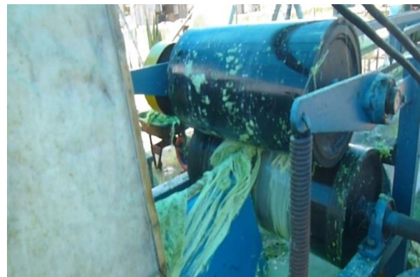
Gambar 4. Mesin dekortikator konveyer mengilas daun agave menjadi serat
