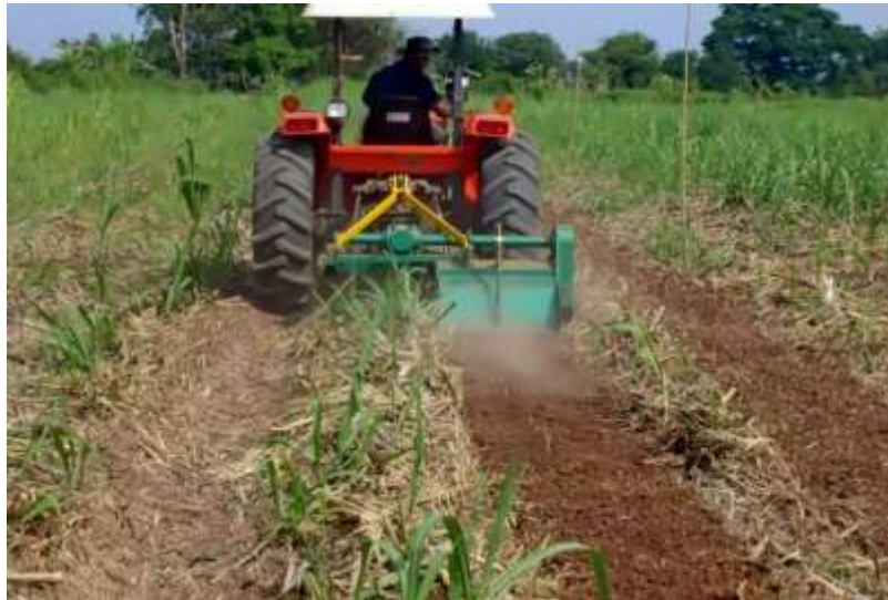
Gambar 3. Proses inkorporasi cacahan tebu dengan tanah secara mekanis menggunakan inter-row cultivator di Thailand (diadopsi dari Khaehanchanpong et al. 2017).
